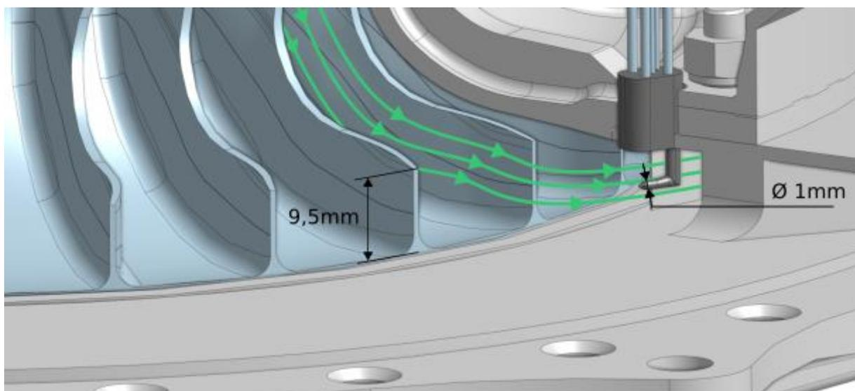
Abbildung 1 – CAD-Anordnung einer Strömungsmesssonde In einem Radialkompressor. Laufblad (blau), Diffusor (grau, aufgeschnitten)
